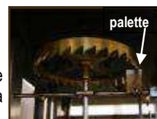
Détail Échappement à roue de rencontre
