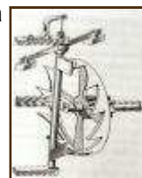
Échappement à foliot in La mesure du temps à travers les âges, 2009.
