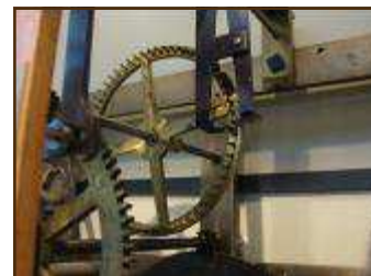
Détail Échappement à cheville
